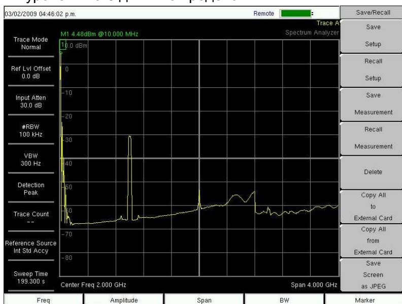
Рисунок 10 Уровень побочных излучений в полосе 4 ГГц
