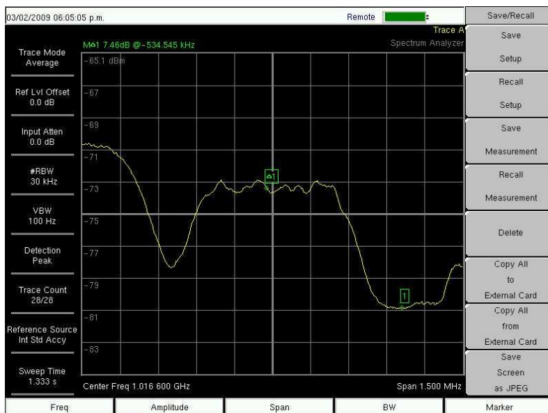
Рисунок 13 Спектр несущей для кодирования 2/3 и уровня ошибок 10E-6.
