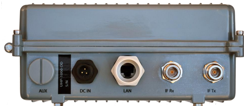
Рисунок 4 Вид интерфейсной панели маршрутизатора серии UHP-1200
